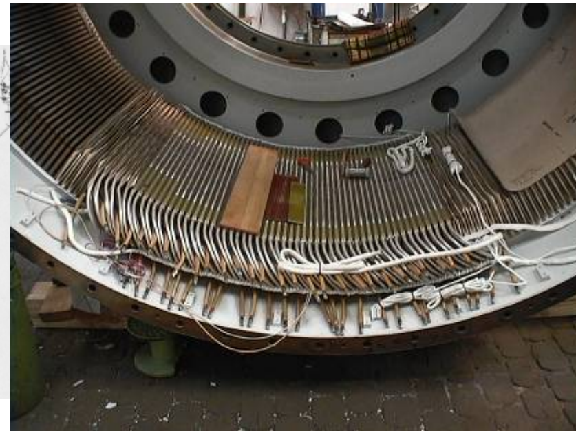
Windgenerator 1250 kVA, 21.5 1/min (Leitner)
