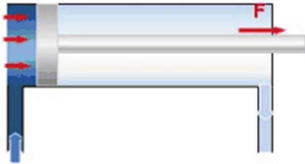
Pneumatikzylinder werden für lineare Bewegungen in Maschinen verwendet.
